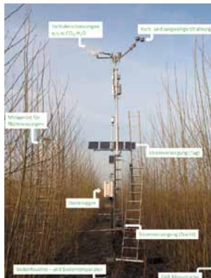
Abb. 2: IGZ betriebene EC Station zur Messung der Netto- $\text{CO}_2$ -Aufnahme einer Pappelplantage. Basis der Methode sind hochfrequente Messungen (10 Hz) der drei Windgeschwindigkeitsvektoren ( $u$ ,  $v$ ,  $w$ ) und der Konzentration des interessierenden Gases ( $\text{CO}_2$ )
