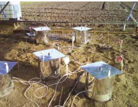
Abb. 5: Gasflussmessung mit geschlossenen Hauben
