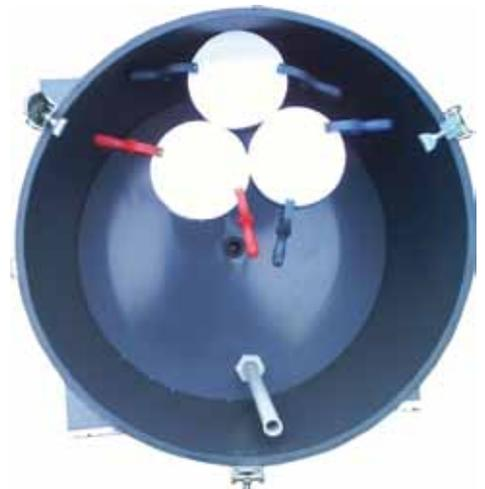
Abb. 8: Haube mit Installation von Filterfallen zur Messung von NH<sub>3</sub>
