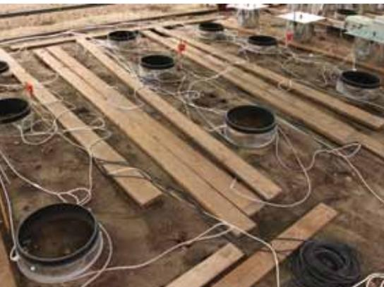
Abb. 4: Installierte Haubenringe für Gasflussmessung
