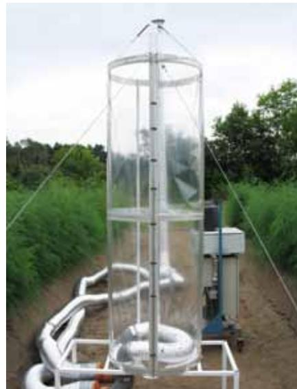
Abb. 1: Küvette (IGZ Eigenbau) zur Bestimmung Netto- $\text{CO}_2$ -Aufnahme von Spargelpflanzen
