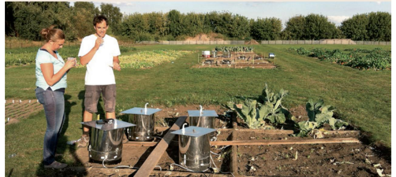
Abb. 3: Messung der Gasflüsse im Kastenparzellenversuch 2013
